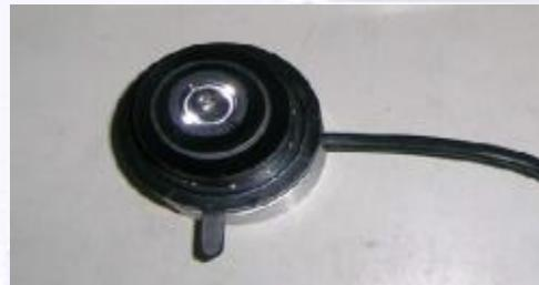
4-3. 自動程式控制表面光源：高亮度多層多角度LED光源
